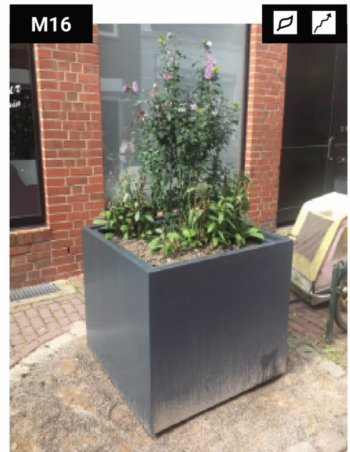
Neben Pollern können auch Pflanzgefäße als Überfahrsperre fungieren.
